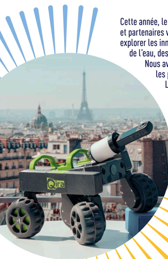
QIRA est un quad radiocommandé sans fil permettant d'inspecter les réseaux secs. Il est utilisé à Marseille, à Mulhouse ou encore à Orléans.
