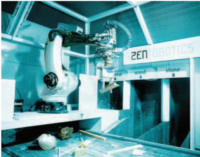
ZenRobotics, un outil à la pointe de la technologie pour optimiser le tri des déchets de construction.
