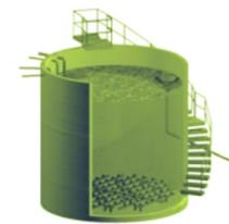
Ce procédé de dégradation biologique aérobie est spécifique aux résidus gras issus des dégraisseurs de la station, boîtes à graisses de restaurants, de cantine... C'est un système compact, autonome et facilement automatisable qui permet de s'affranchir des frais de transport des déchets gras vers les décharges ou les usines d'incinération.
