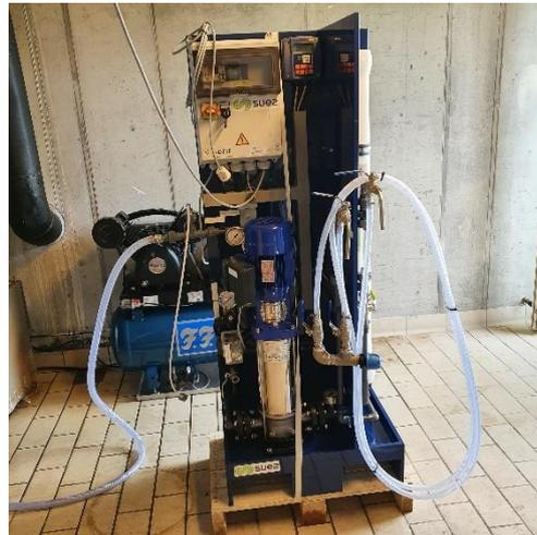
*SUEZ' Nanofilterings Pilotanlæg arbejder 100% automatisk, selvom det er nødvendigt med regelmæssig overvågning af flow, tryk og ledningsevne for at undgå tilstopning.*
